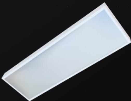
Светодиодные светильники серии ATUM для искусственного освещения помещений монтируются в составе подвесного потолка системы "Армстронг". По световым параметрам светильники ATUM идентичны существующим аналогам на люминесцентных лампах, но они в 2 раза экономичнее и значительно удобнее в эксплуатации, так как на протяжении всего срока эксплуатации светодиодного светильника не требуется замена источников света.
